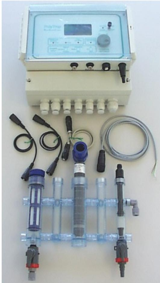
Microprozessorgesteuerte 3-Kanal Mess-, Regel- und Dosieranlage nach DIN 19643 zur Messung des PH-Wertes, des Redox-Potentials und der Konzentration an freiem Chlor.
